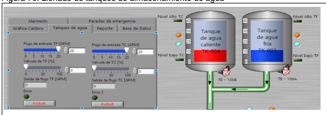
Figura 70. Llenado de tanques de almacenamiento de agua
