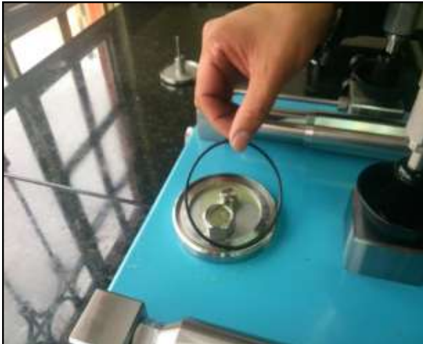
Imagen 32. Verificación anillo de ajuste
