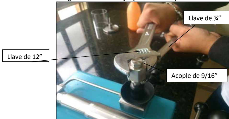
Imagen 41. Sellado y ajuste de acople
