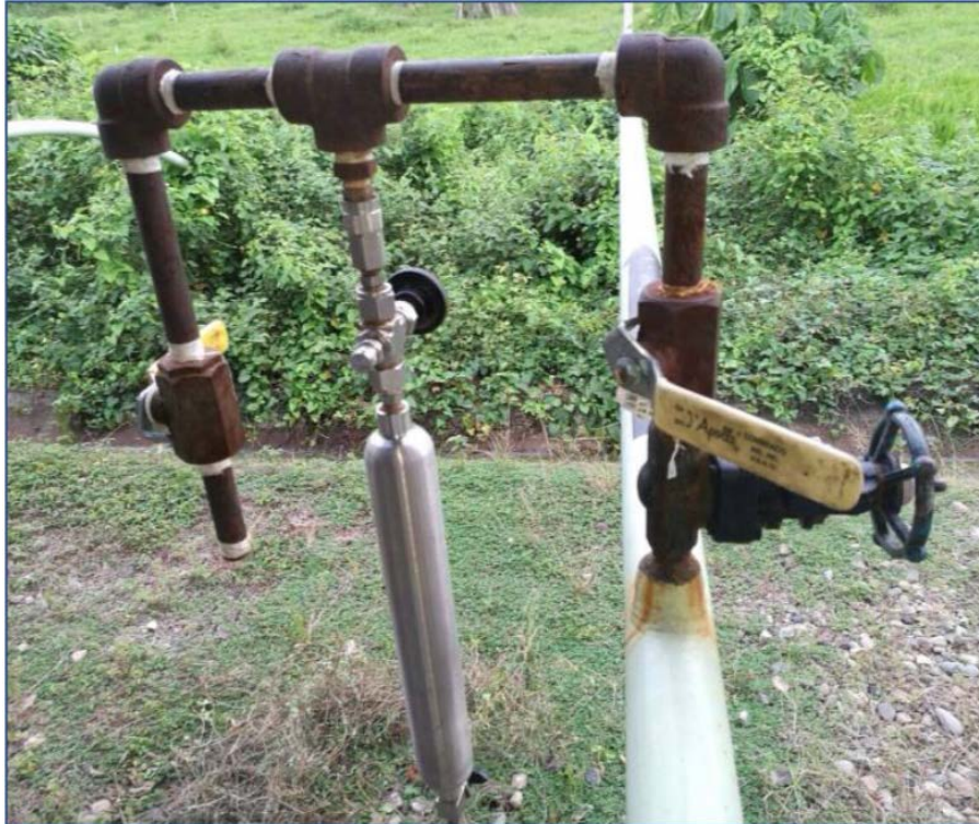
Figura 6. Toma muestra de solución polimérica en campo
