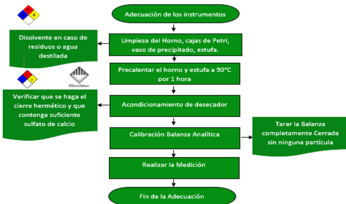
Diagrama 3. Adecuación de los instrumentos para el acondicionamiento del yacón
