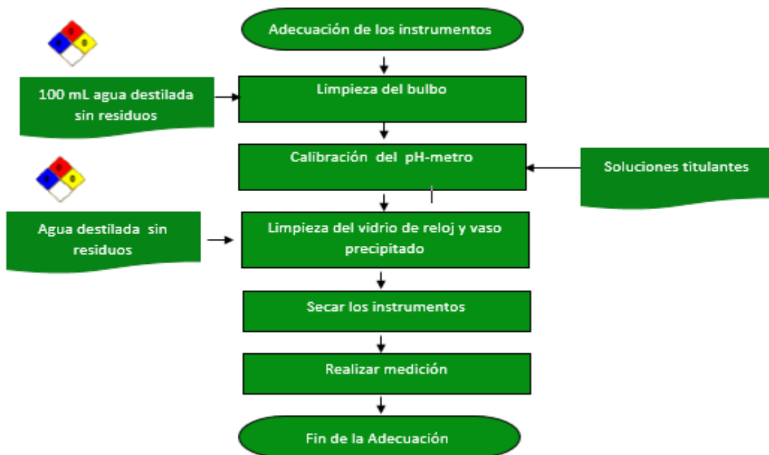
Diagrama 10. Adecuación de los instrumentos para hallar el pH
