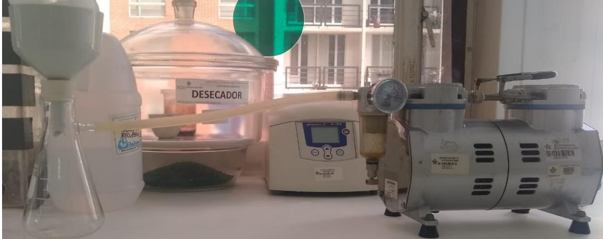
Imagen 4. Montaje para la filtración al vacío de las muestras de ALU.
