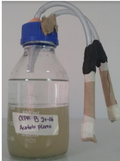
Imagen 3. Montaje de la prueba de detección cualitativa de ácido sulfhídrico.
