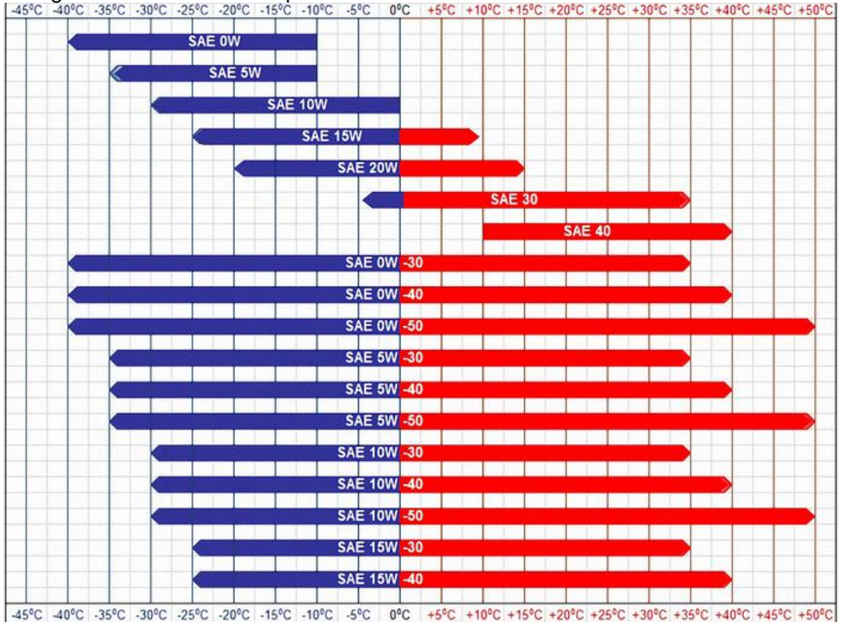
Figura 1. Rangos de temperatura ambiente en que los aceites monogrado y multigrado satisfacen los requerimientos de la norma SAE J300.
