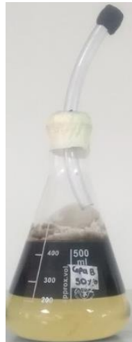
Imagen 5. Montaje del tratamiento biológico de los aceites lubricantes usados.
