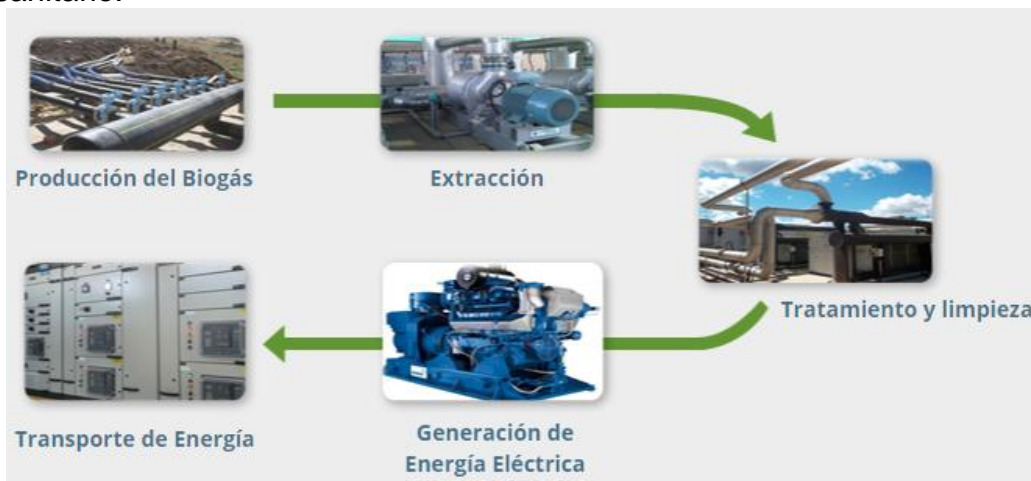
Ilustración 2. Ciclo de producción de energía a partir de biogás de relleno sanitario.
