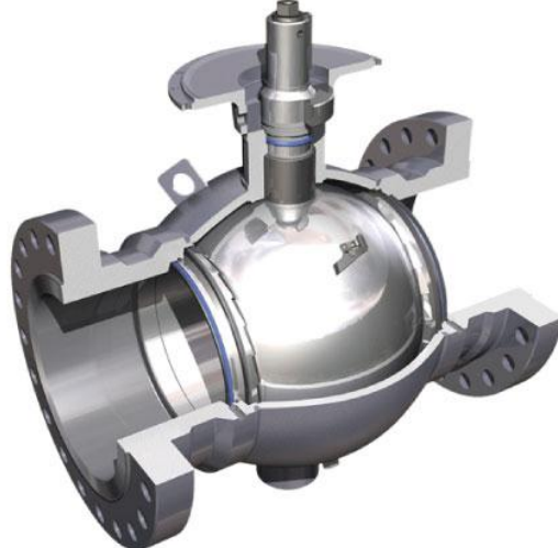
Ilustración 22. Imagen interna de una válvula tipo bola.
