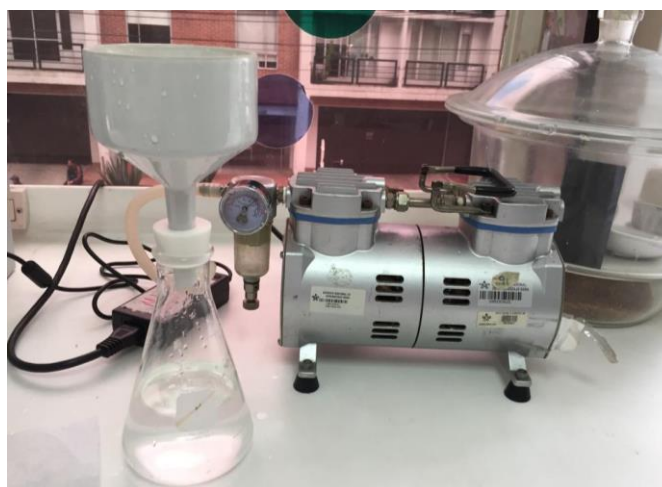
Figura 9. filtración con bomba de vacío.
