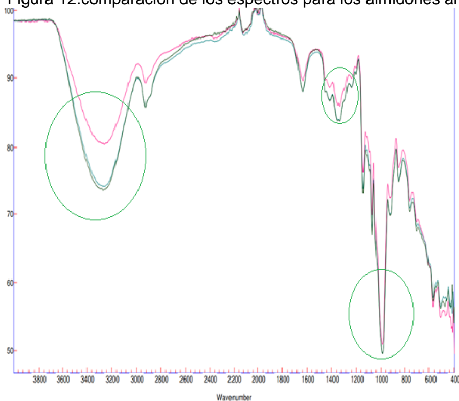
Figura 12.comparación de los espectros para los almidones analizados.
