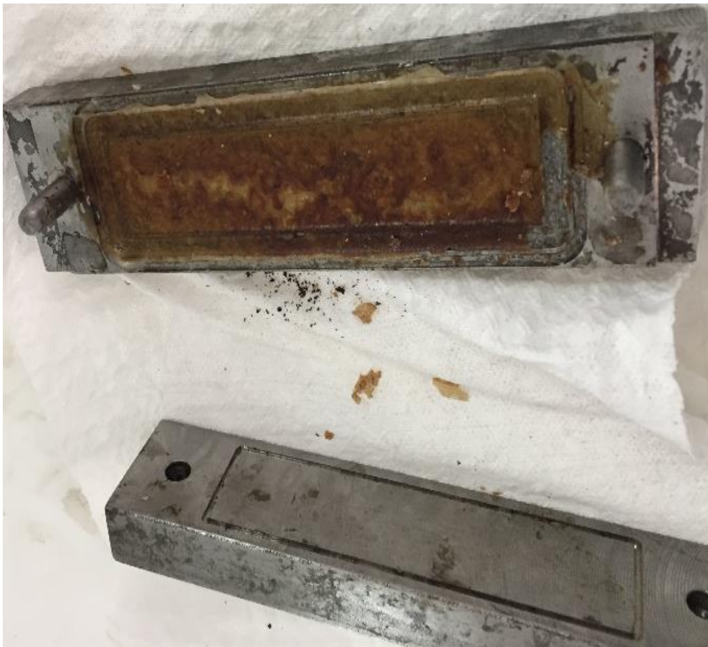
Figura 18. Molde de acero GGD MP 420, con el bioplástico.
