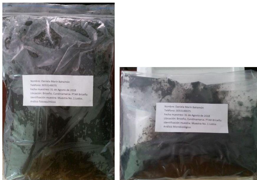
Imagen 10. Muestra de lodo obtenida y llevada a análisis fisicoquímicos y microbiológicos.
