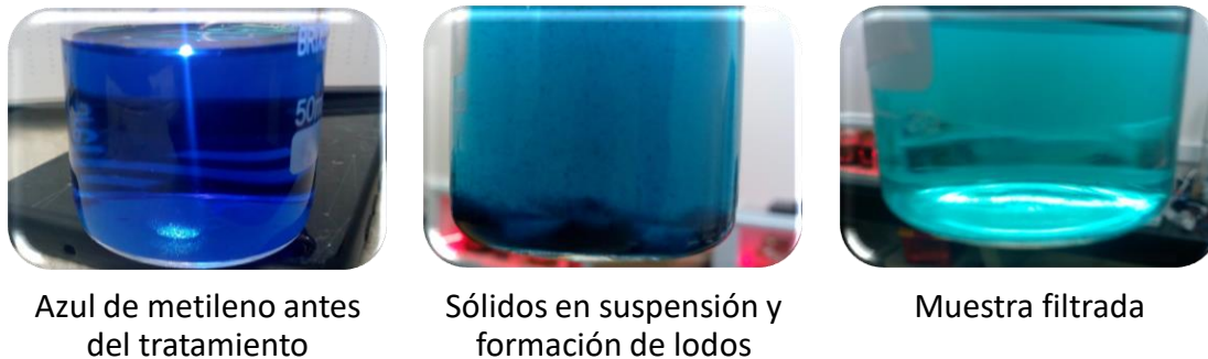
Figura 14. Pasos del tratamiento en azul de metileno.
