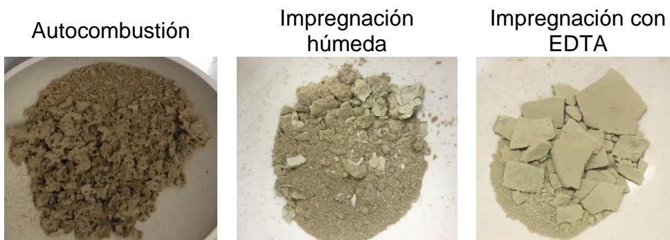
Imagen 11. Catalizadores 5% Ce/Cu-Mn por diferentes métodos de incorporación
