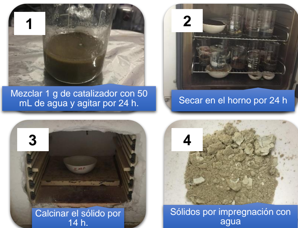
Imagen 7. Procedimiento método Impregnación con Agua
