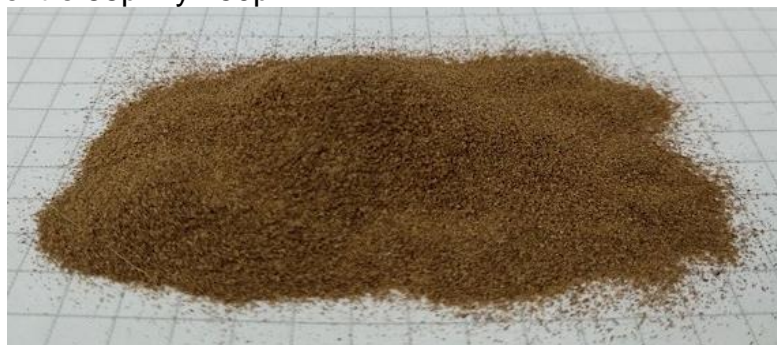
Figura 19. Cáscara de cacao con tamaño de partícula entre 88µm y 150µm.
