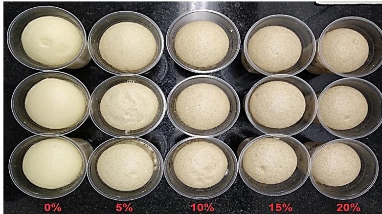
Figura 21. Tonalidad café creciente en las espumas de PU.
