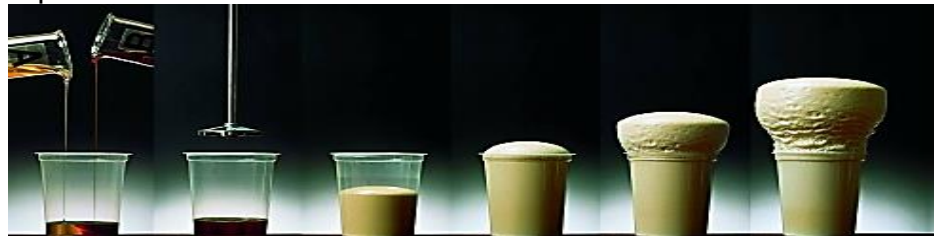
Figura 9. Mezcla de componentes A y B para la formación de la espuma de PU.
