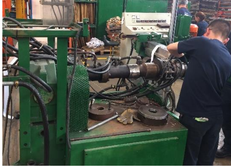
Imagen 6. Puesta a punto de la extrusora.
