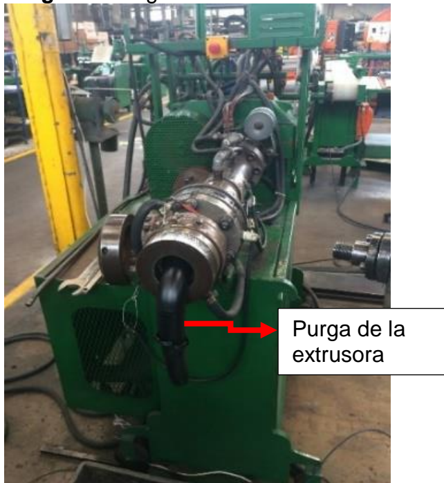
Imagen 7. Purga de la extrusora.
