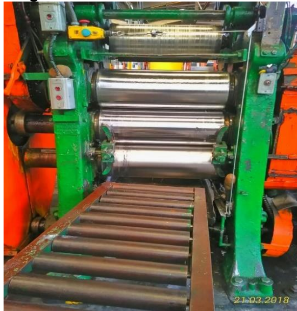
Imagen 4. Serie de molinos reductores de grosor
