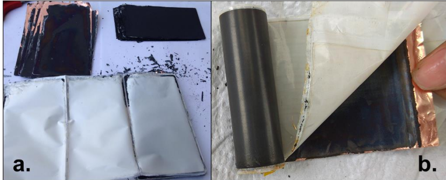
Figura 13. Distribución interna de las celdas. a). Celdas rectangulares. b). Celdas cilíndricas
