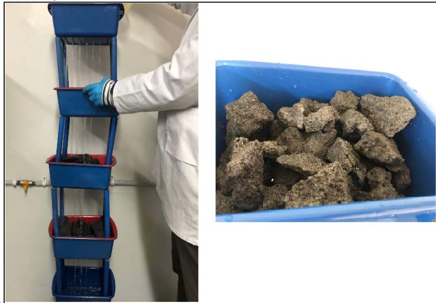
Figura 9. Prueba experimental de aireación por torre de bandejas
