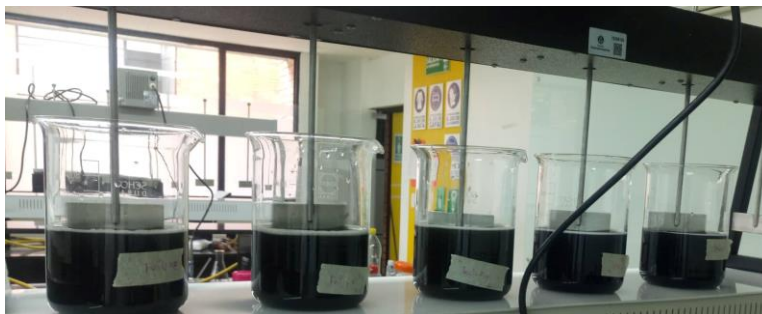
Ilustración 7. Floculador test de jarras.
