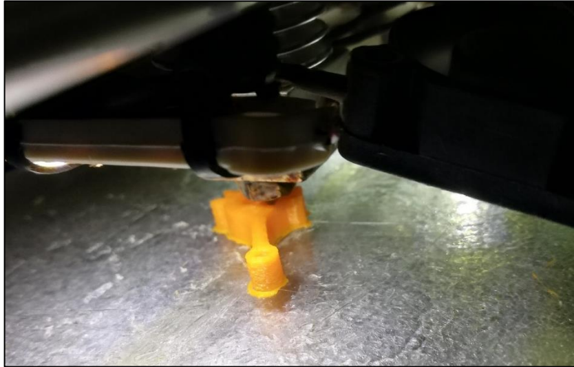
Figura 83. Prototipado del engranaje del efector final
