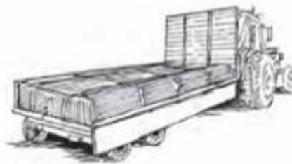
Figura 2 Camión cisterna improvisado
