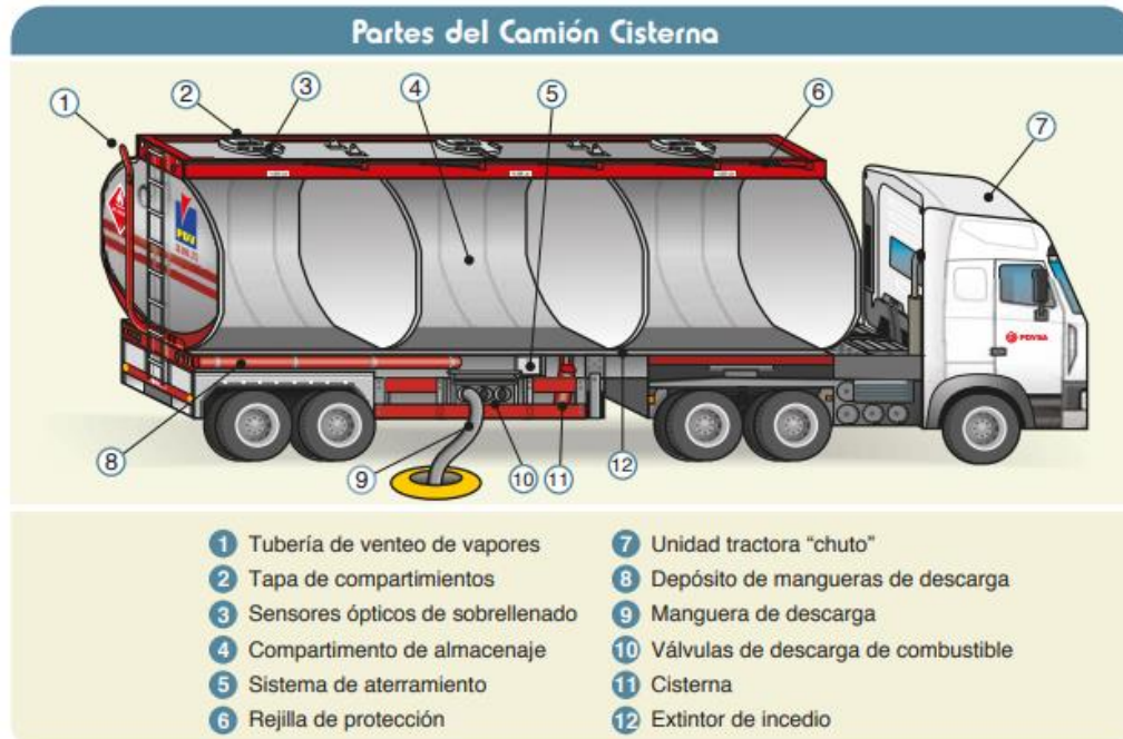
Figura 6. Partes del Camión cisterna.
