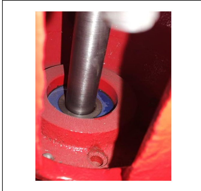
Figura 41. Eje calibrado ajustado al retenedor.
