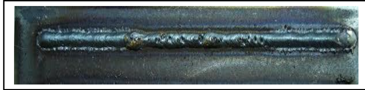
Imagen 15. Cordón de soldadura defectuoso
