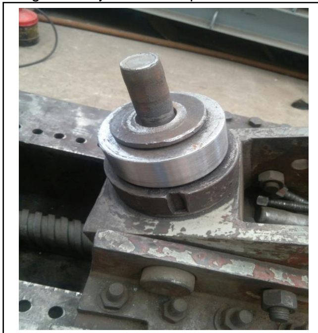
Imagen 30. Eje central de pestañadora
