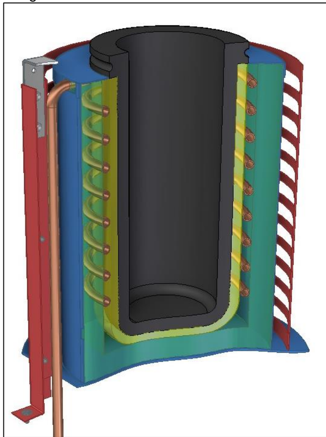
Imagen 37. Paredes del horno de inducción
