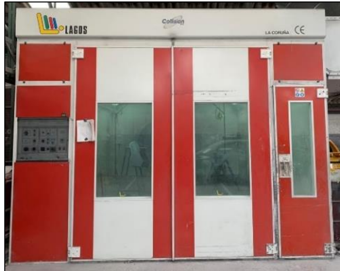
Imagen 33. Cabina de pintura
