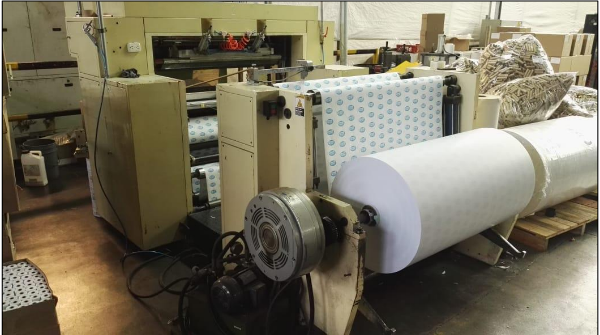
Figura 61. Máquina rebobinadora y cortadora de papel actual.
