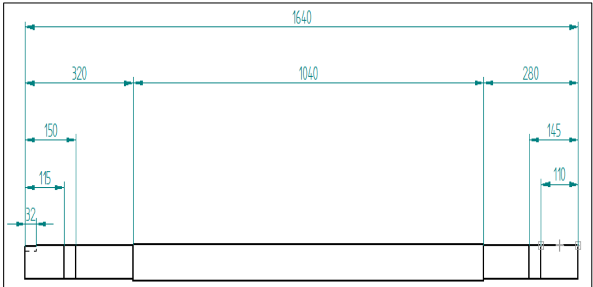
Figura 54. Vista frontal eje principal.
