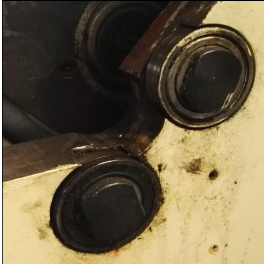
Figura 60. Ubicación de rodamientos.
