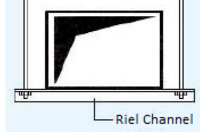
Figura 29. Montaje de ductos
