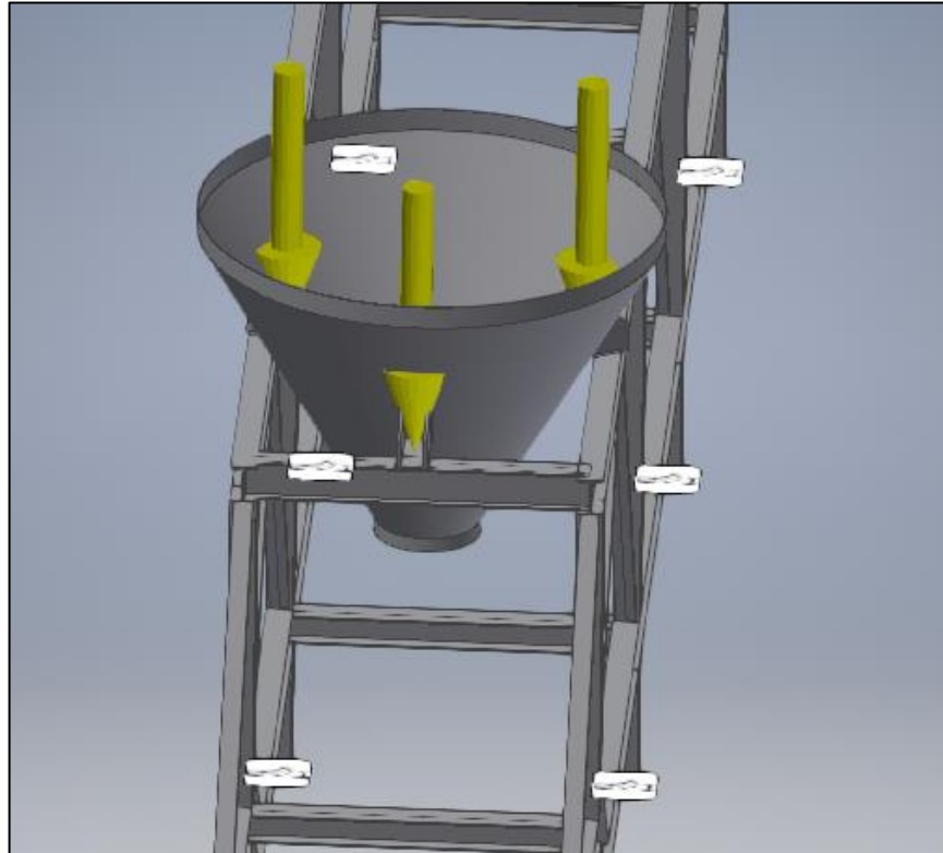
Figura 51. Cargas aplicadas en el chasis
