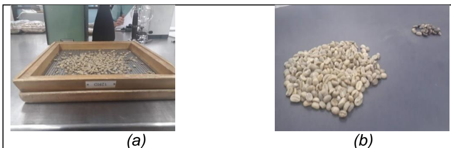
Ilustración 5. Determinación de (a) ripio y (b) defectos y materia extraña.
