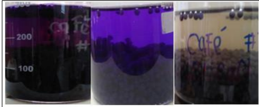
Imagen 15. Adsorción de colorantes en esferas de borra de café
