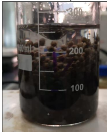
Imagen 16. Adsorción de Hg en perlas de alginato de calcio y café
