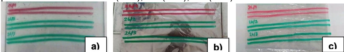
Figura 64. Trazos realizados sobre a) vidrio, b) aluminio y c) plástico. (Día cero) para las formulaciones 4-1 (26/1), 4-2 (26/2), 4-3 (26/3)
