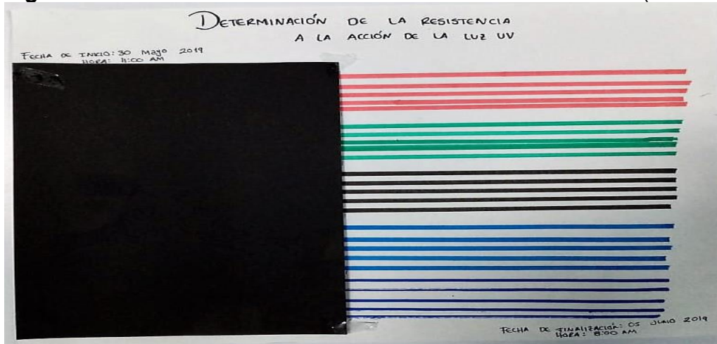
Figura 75. Determinación de la resistencia a la acción de la luz (hora cero)
