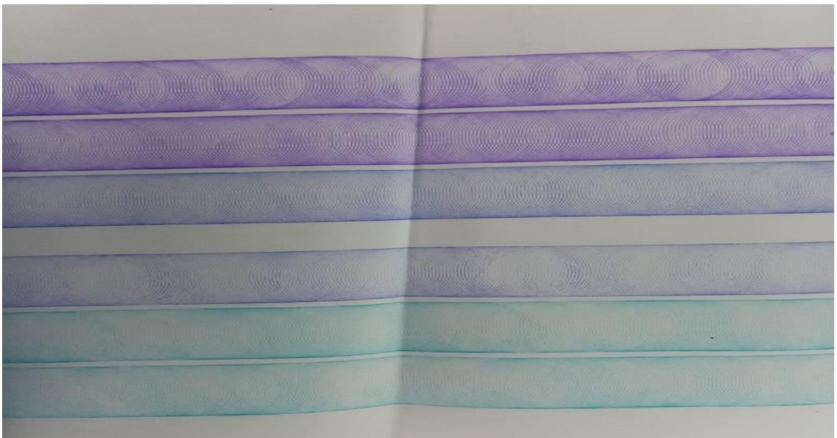
Figura 16. Prueba de escritura, fluidez y estabilidad realizada en Pelikan para las tintas
