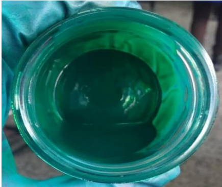
Figura 63. Tinta 4-3 luego de prueba de estabilidad de 72 h. Según la norma NTC 2223
