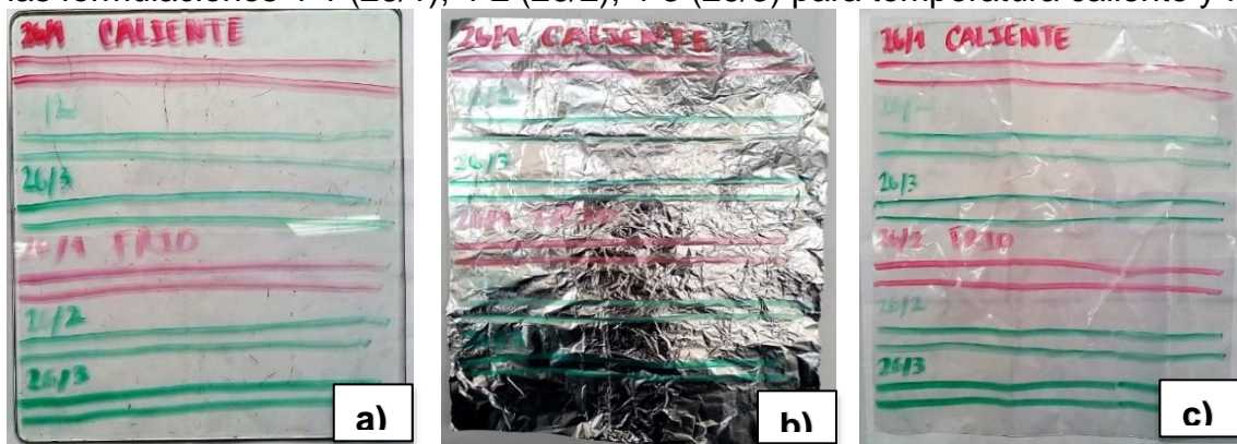
Figura 65. Trazos realizados sobre a) vidrio, b) aluminio y c) plástico. (Día 22) para las formulaciones 4-1 (26/1), 4-2 (26/2), 4-3 (26/3) para temperatura caliente y frío
