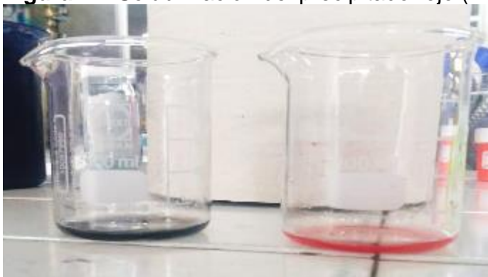
Figura 44. Solubilización del precipitado rojo (RR) y negro (RN) con propanol
