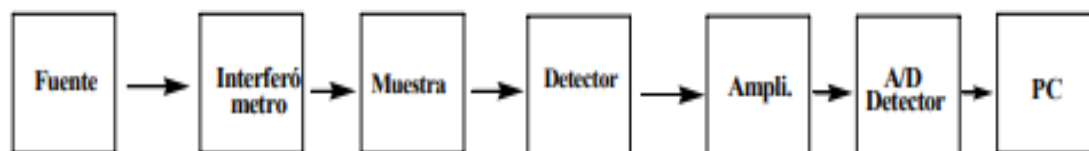
Figura 21. Funcionamiento de la espectroscopia por transformada de Fourier (FTIR)
