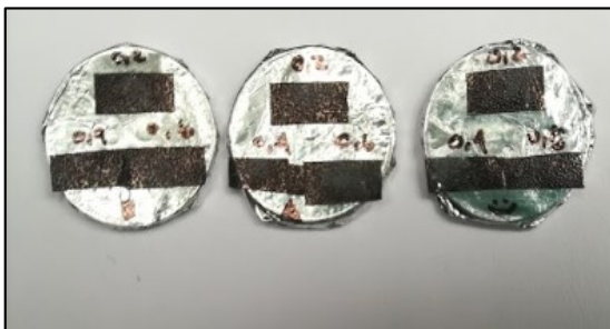
Imagen 17. Muestras metalizadas con Au para análisis SEM.
