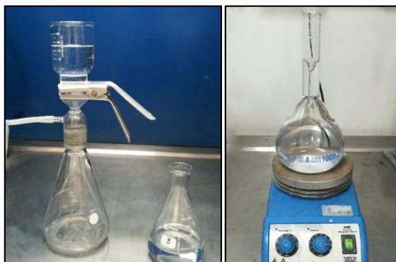
Imagen 18. Proceso de filtración al vacío y solución incolora obtenida.
