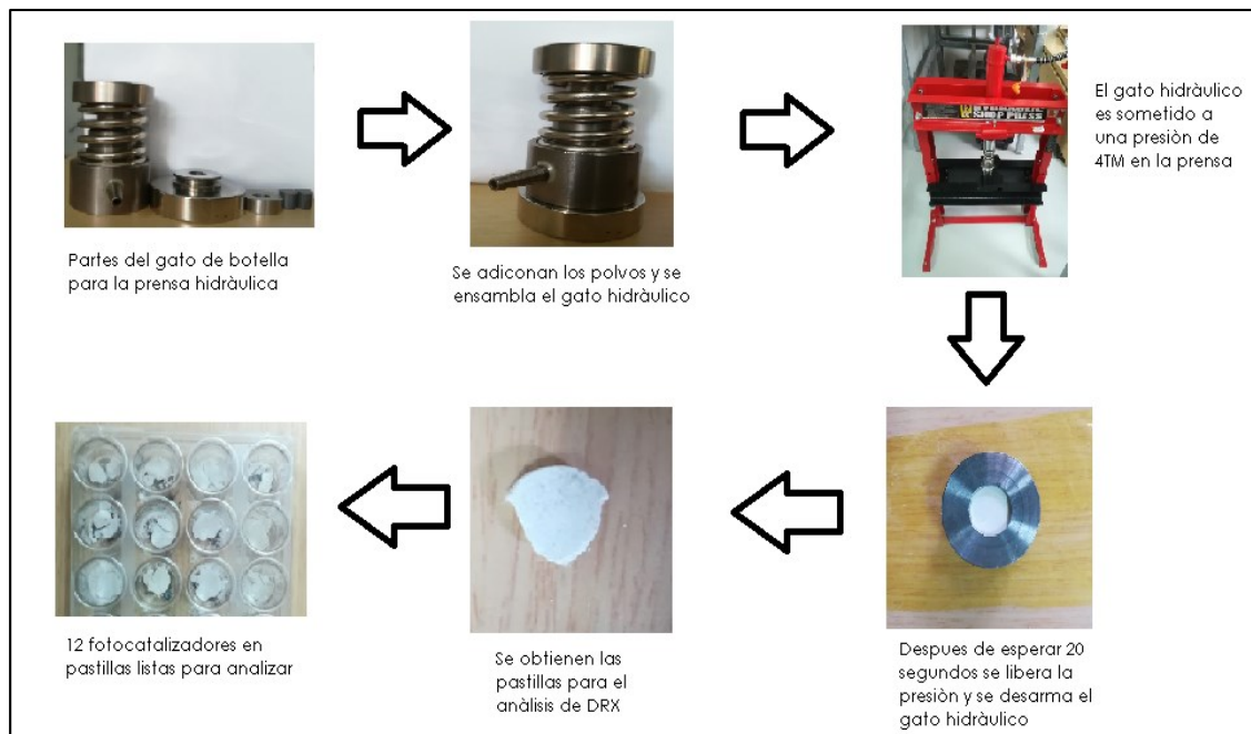
Imagen 10. Proceso de pastillaje para análisis de DRX.
