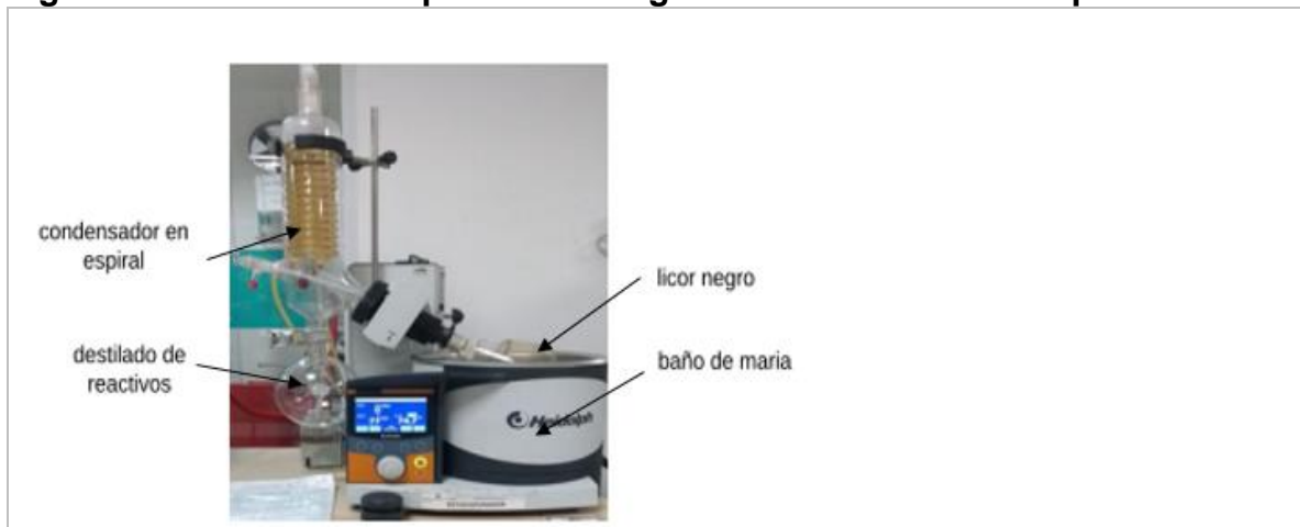
Figura 27. Proceso de separación de lignina mediante el Rotavaporador.
