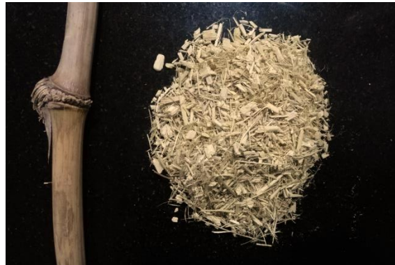
Figura 13. Bambú seco y bambú seco triturado para carbonización
