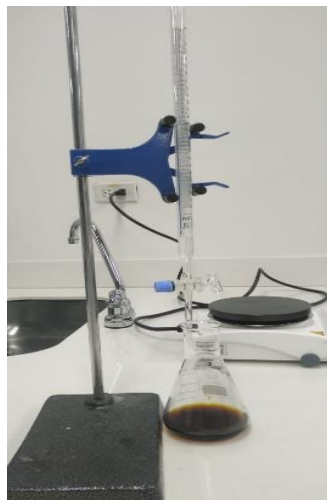
Figura 17. Titulación de solución de yodo residual, con solución de tiosulfato de sodio 0,1N la cual se rectifica con una solución de almidón estándar.
