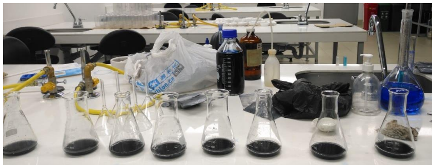
Figura 18. Muestras de carbón activado impregnadas con la solución de azul de metileno
