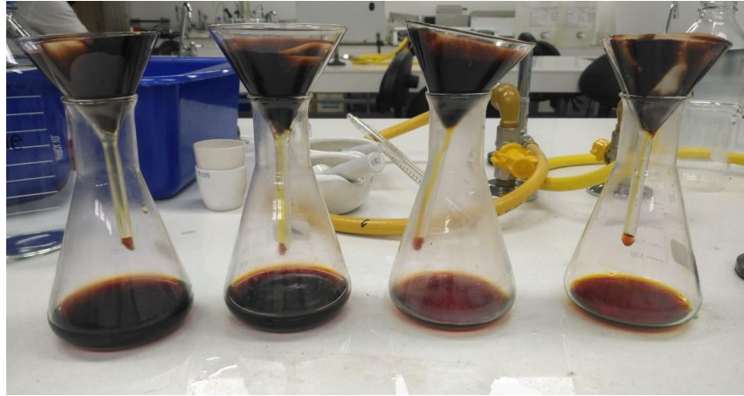
Figura 16. Filtración de las muestras de carbón activado impregnadas con la solución de yodo 0,1N.
