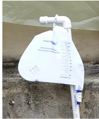
Ilustración 18. Recolector de biogás
