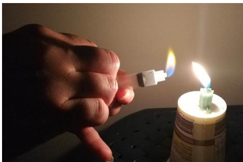
Ilustración 37. Combustión del metano producido
