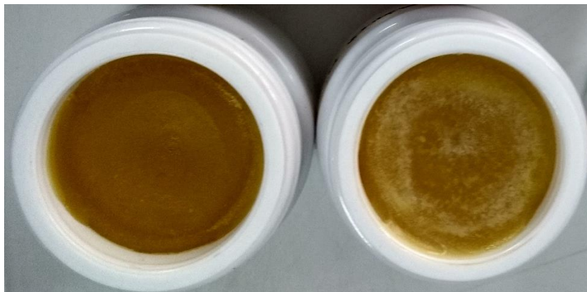
Imagen 19. Formulación en estado líquido y posterior aparición de burbujas sobre la superficie de la pomada.
