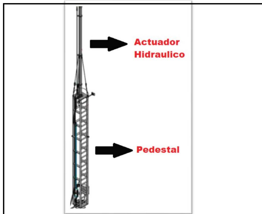
Figura 25. Actuador Hidráulico y Pedestal
