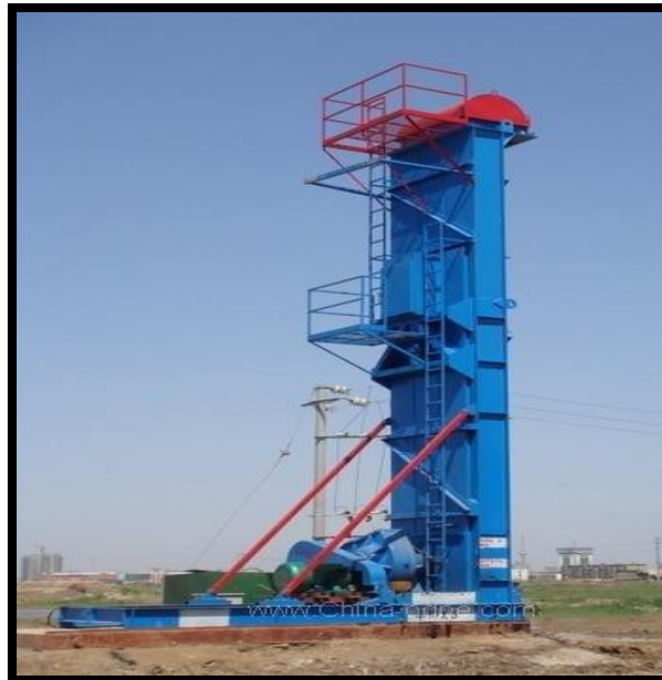
Figura 21. Unidad de bombeo Rotaflex
