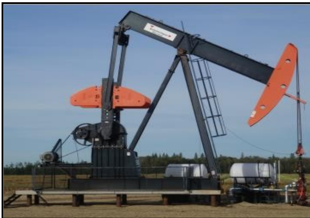
Figura 18. Unidad de Bombeo Mecánico Convencional
