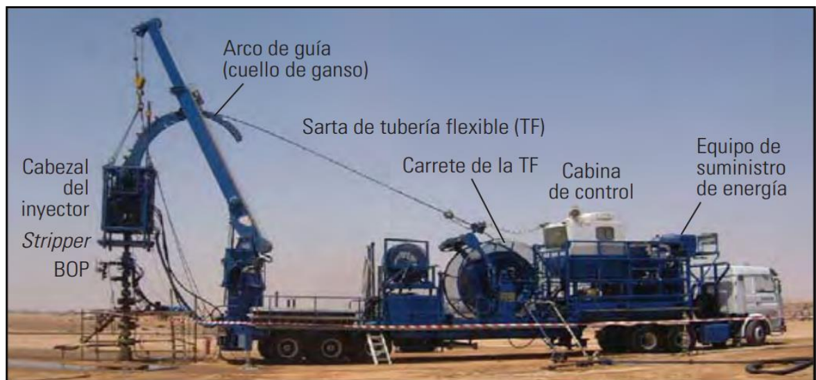
Figura 3. Componentes de la unidad de tubería flexible
