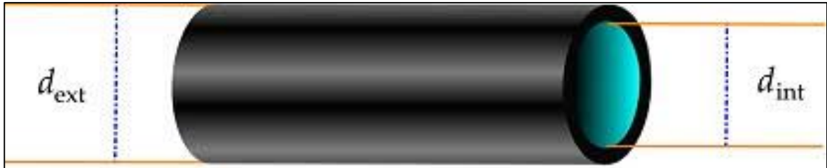
Figura 2. Diámetros en tuberías cilíndricas
