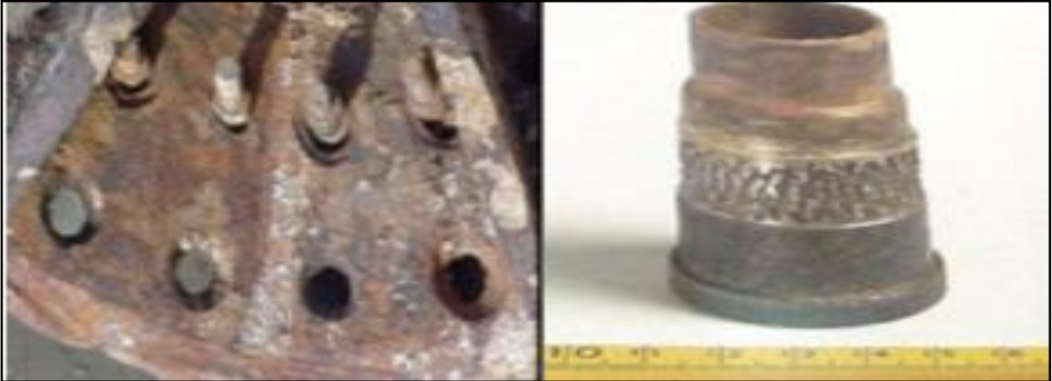
Figura 19. Representación de la corrosión galvánica
