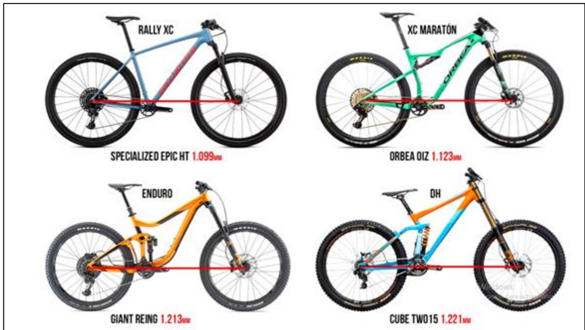
Figura 8. Geometría: Distancia entre ejes.
