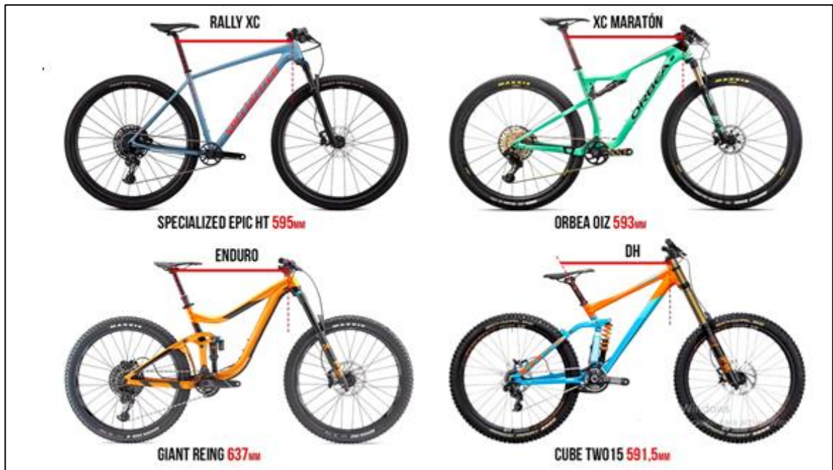
Figura 7. Geometría: Longitud del tubo horizontal.
