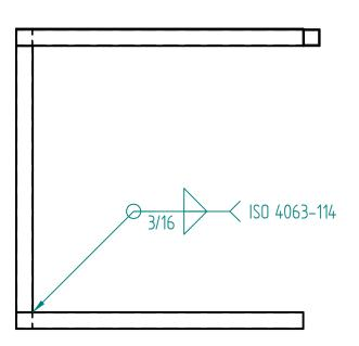
nota: La union estructural se realiza con soldadura y un electrodo E7018, se recomienda usar la norma ISO 4063-114
