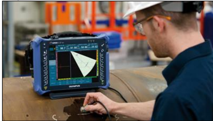
Imagen 49. Inspección por ultrasonido
