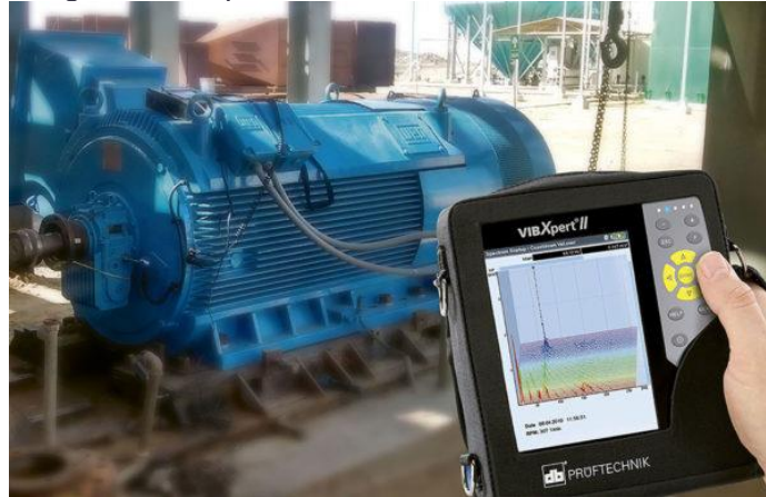
Imagen 50. Inspección de vibraciones
