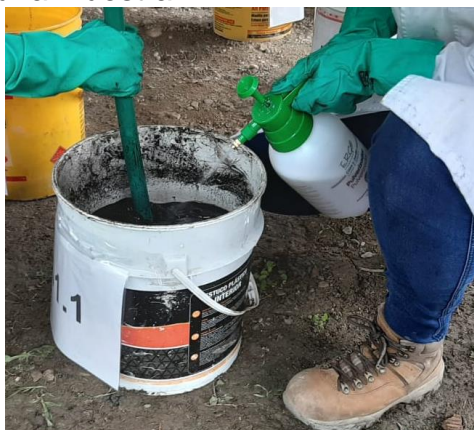
Imagen 5. Aplicación de la mezcla de OSE II y Agua, a una muestra
