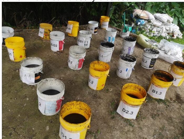
Imagen 3. Distribución de los recipientes del suelo contaminado con diésel y biodiésel
