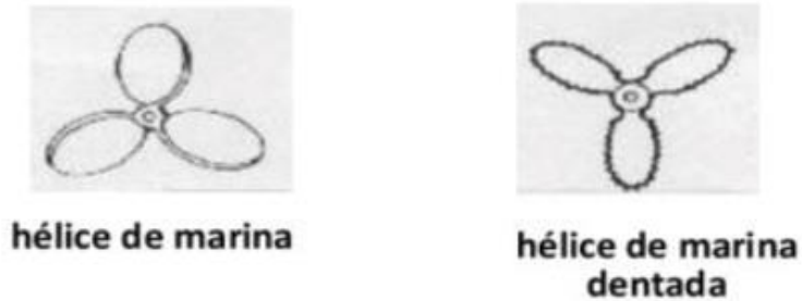
Figura 9. Tipos de agitadores de hélice.
