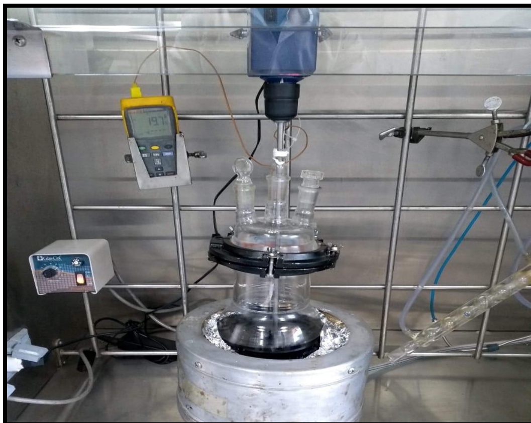
Ilustración 11 Montaje reactor carbon activado en polvo.
