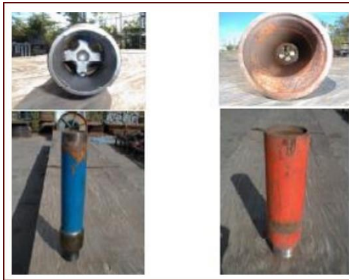
Figura 33. Equipo PCP: pin de paro.
