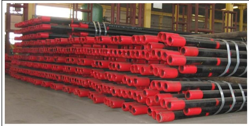
Figura 27. Equipo PCP: tubería de producción.
