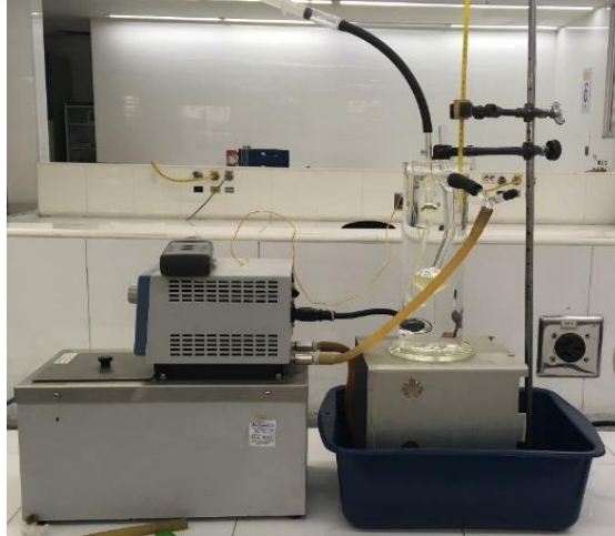
Imagen 18. Montaje para la determinación viscosidad cinemática.
