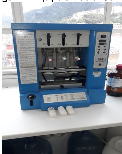
Imagen 12. Equipo extractor Soxhlet.
