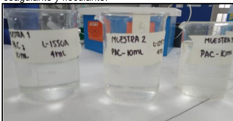
Figura 23. Ensayo 2 determinación dosis óptima de coagulante y floculante.
