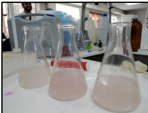
Figura 20. Neutralización del agua residual con NaOH al 10% v/v.
