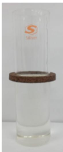
Fig.1. Anillo de corcho sobre la celda de medición.
