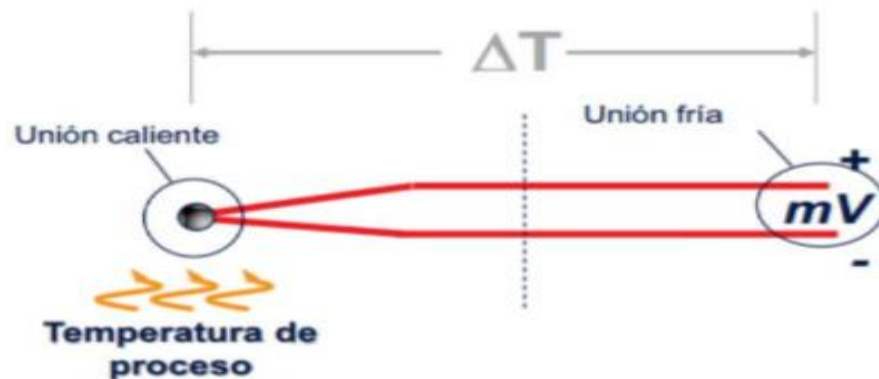
Figura 27. Termocupla o termopar, efecto Seebek.
