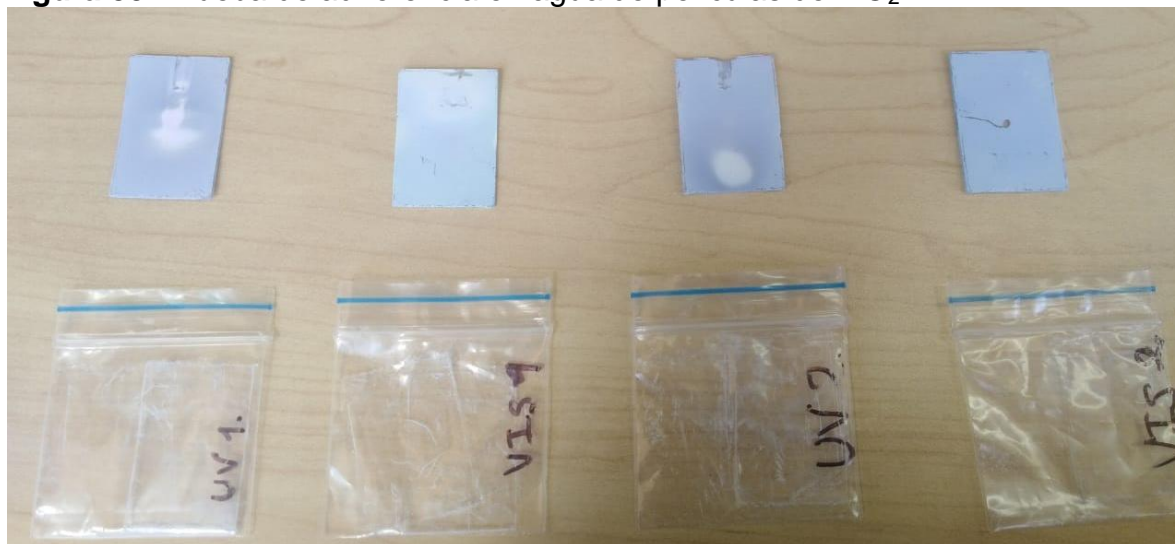
Figura 35. Prueba de adherencia en agua de películas de TiO 2 .
