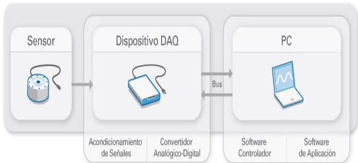
Figura 10. Partes de un Sistema DAQ.
