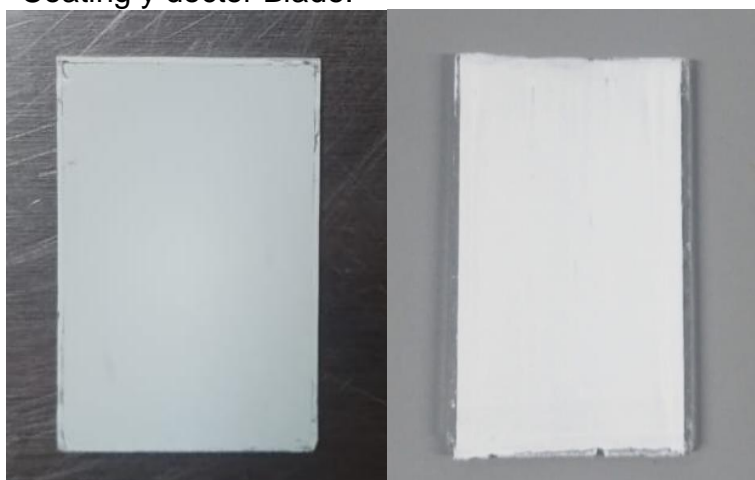
Figura 29. Películas obtenidas por los métodos Spin Coating y doctor Blade.
