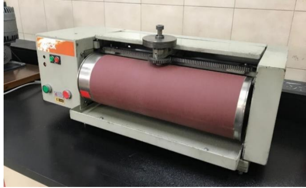
Imagen 21. Abrasímetro de suela Zwick.
