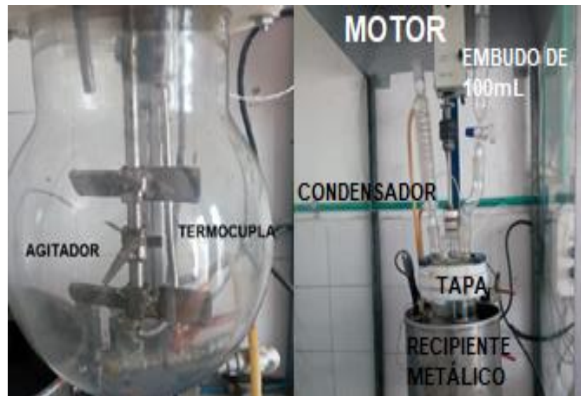
Ilustración 33. Partes del reactor piloto
