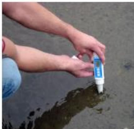
Con el peachímetro resistente al agua PCE-PH 22 puede medir rápidamente el valor pH. También se le indica en la pantalla la temperatura actual.
