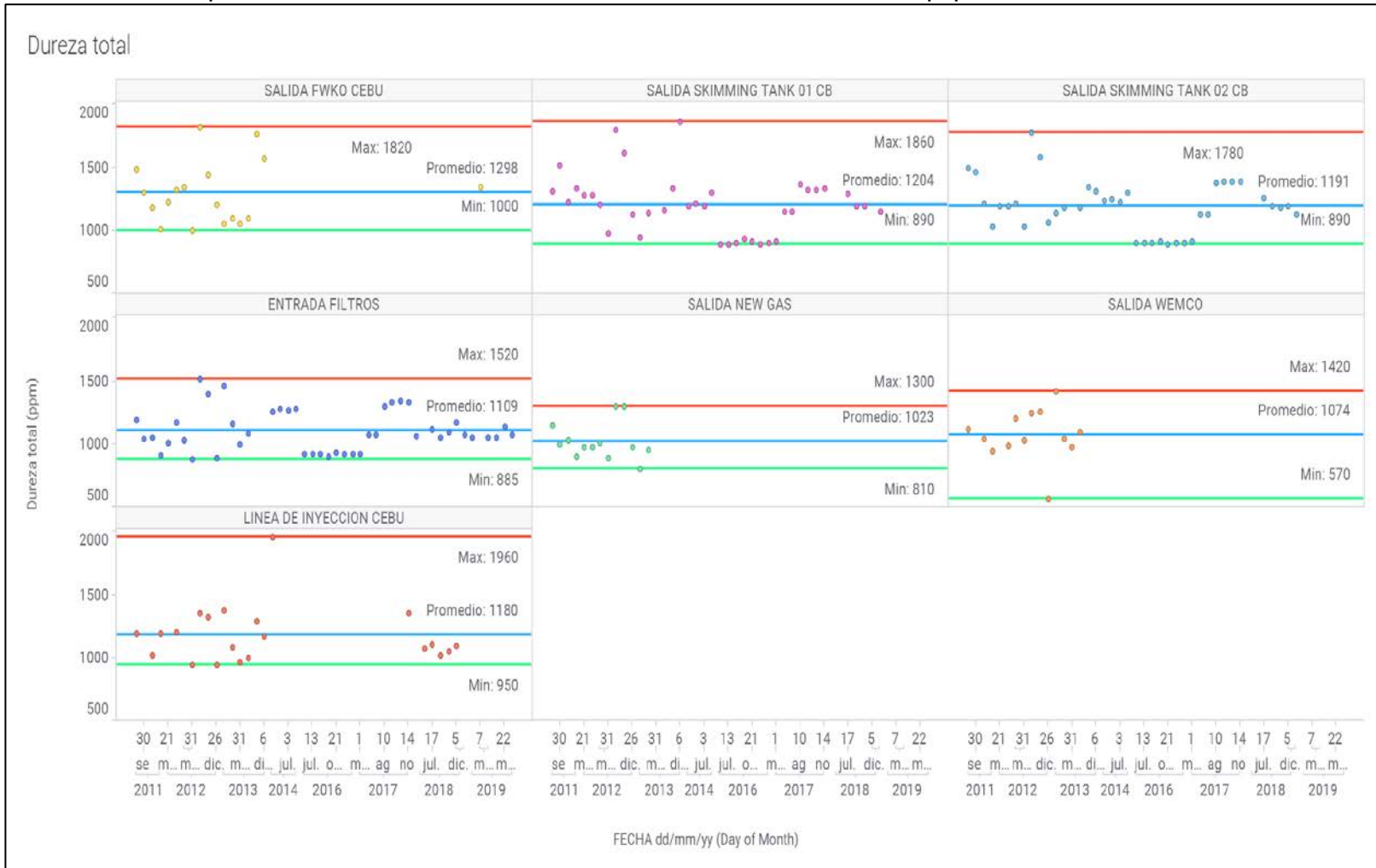
Gráfica 10. Comportamiento secuencial de la dureza total en los distintos equipos de la PIA.
